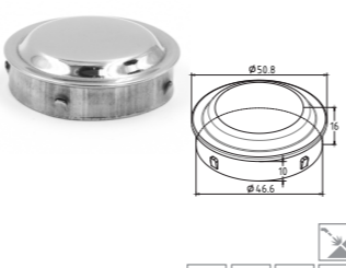
k037 Заглушка поручня штампованная, для трубы \varnothing 50 x1.5 x0.75 мм (утолщен., фигурная под сварку)
