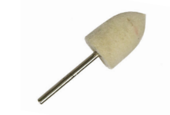
к460 Войлочная насадка д.14x20мм. Плотно сбитая из японского войлока. Для полировки внутри пластинчатых стоек. 1000 GRIT.
