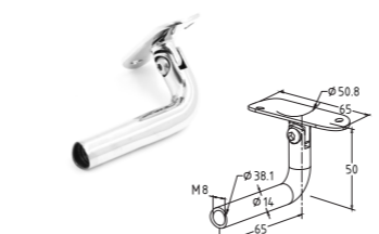
k261-4 Держатель поручня выносной на стойку, с регул. ложементом под \varnothing 38.1 и 50.8 мм, резьба внутр. M8
