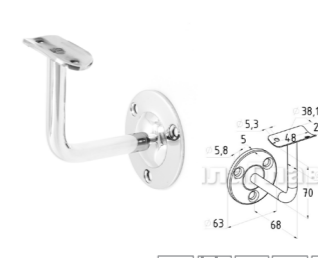
k010-6 Пристенный держатель поручня литой \varnothing 38.1 мм сварной, полированный, AISI 201
