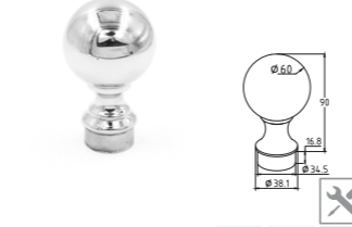
k070 Наконечник шар на стойку \varnothing 38.1 мм, литой, полированный, AISI 304
