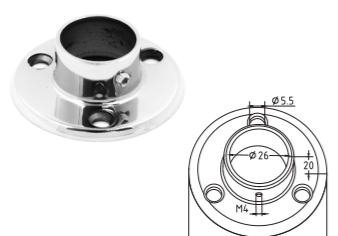
k355 Фланец под трубу Ø25.4 мм, полированный, литой, под три самореза 4.2мм
