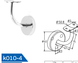
k010-4 Пристенок с ложементом под 50.8 мм, вынос 70x45, \varnothing 60 \times 3 мм, сварной с крышкой 25x45x2 мм
