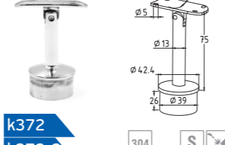
k372 k372-2 k372-3 Наконечник палец на стойку \varnothing 42.4 \times 1.5 мм, с регулируемым ложементом под трубу \varnothing 50.8 мм, литой, полированный, AISI 304
