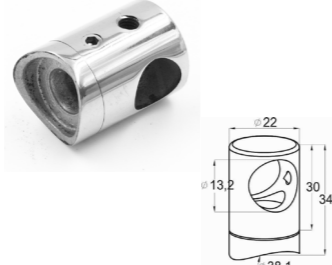
k029 Ригелдержатель на стойку Ø38.1x13.2 мм, полированный, литой, AISI 304
