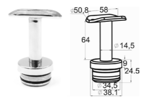
k199 Наконечник с системой фиксации на стойке \varnothing 38.1 \times 1.5 мм, с не регулируемым ложементом 90^\circ под поручень \varnothing 50.8 мм, полированный, AISI 304
