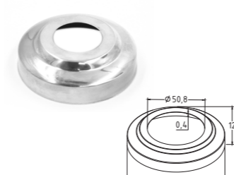
k007-9 304 P X Низ стойки Ø50.8 мм, S=0,4 мм, внешний Ø95x12 мм, полированный 400# (AISI 201)
