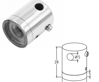
k267-5 Держатель тросика Ø5 мм, 22x30 мм, под Ø48.4 мм, полированный, AISI304
