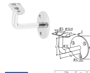
k010-2 Пристенный держатель поручня \varnothing 50.8 мм с ложементом, сварной
