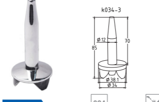
k034 k034-3 Наконечник внутренний на стойку \varnothing 38.1 мм, без ложемент, литой, полированный, под сварку, облегченный, AISI 316
