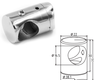
k018-5 Ригелдержатель на трубу Ø38,1x16,5 мм, с потаем под вытяжную резьбовую заклепку
