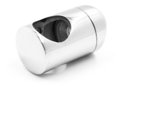
k018-4 Ригелдержатель на трубу Ø38,1x16,8 мм, AISI 316, с потаем под вытяжную резьбовую заклепку
