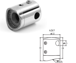
k267 Держатель тросика Ø6 мм, 22x30 мм, под Ø42.4 мм, AISI304
