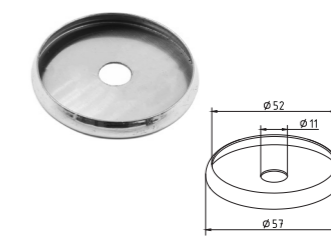
k098 201 P X Шайба подкладочная Ø50.8 мм, 57x6, с отверстием Ø11 мм (AISI 201)
