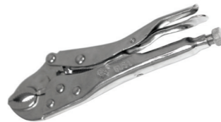
к928 Пассатижи фиксирующие (пинцы). Сварщик может сваривать один, ему не требуется помощь.
