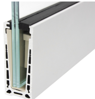
k601-2 Профиль алюминиевый зажимной 118x45 мм для несущего стекла 10-16 мм, анодированный, матовый, длина 6 метров, облегченный
